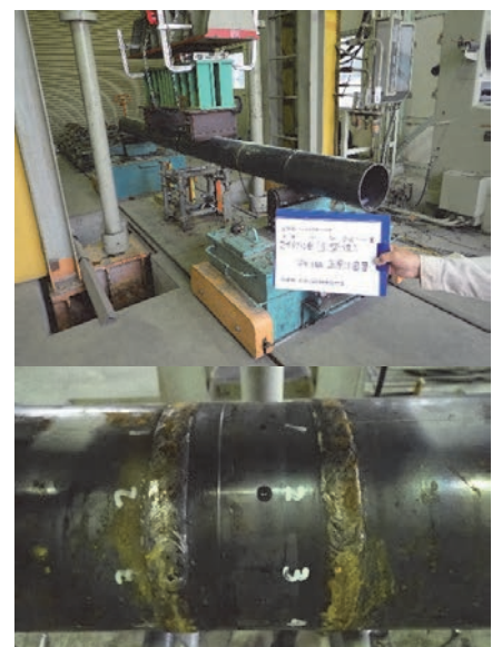
写真 曲げ試験状況
