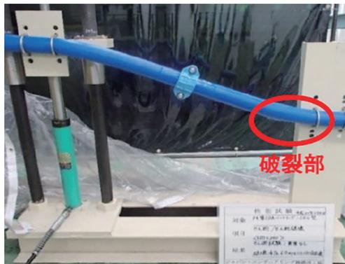
せん断破壊試験後 (4.0MPa 以上) ※
