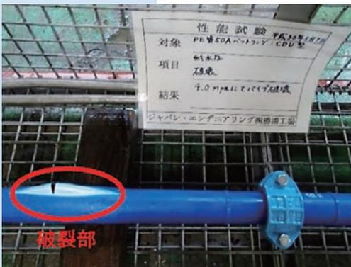
破壊試験後 (4.0MPa 以上) ※
