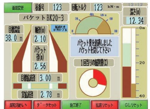
拡底部掘削時
