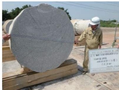
拡径部の断面寸法計測
