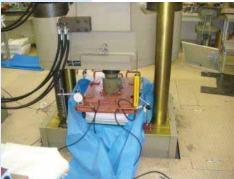
土袋 鉛直耐荷試験
