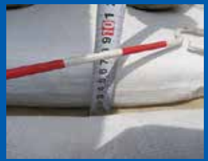
⑩土間部高さ測定
