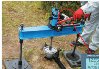
引抜き試験状況
