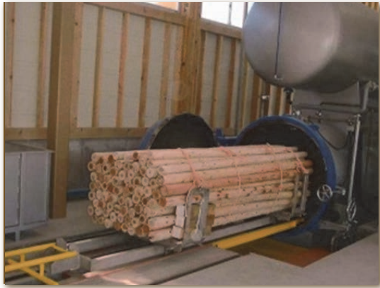
木杭は、木材防腐防蟻剤（タナリスCY）の加圧注入により長期に防腐防蟻効果が維持する。
