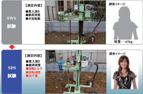
図-1 SWS試験とSDS試験の比較
