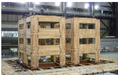
写真 2 CLT パネル構造の振動台実験
