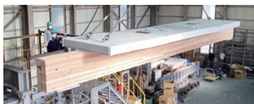
写真1 試験前の合成梁の様子
