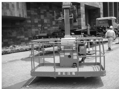
写真1 高さ50m級の高所作業車
