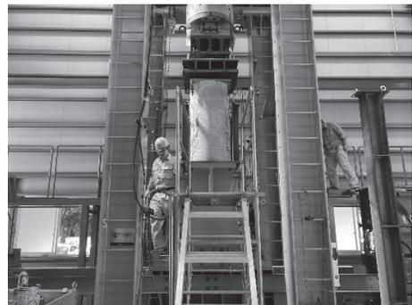
大型一軸圧縮試験の様子
