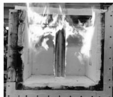
汎用小型加熱炉は可変機構を有し、加熱面の大きさや開口方向が任意で設定可能です。また、大型加熱炉と同様の加熱条件・温度調整で試験が可能であり、小規模な試験によって性能検証に要するコストを削減することが出来ます。
