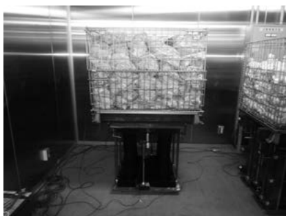
写真 28 プラスチック雨水貯留槽クリープ試験
