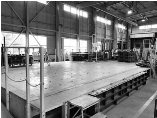
写真1 第1試験棟 反力床
