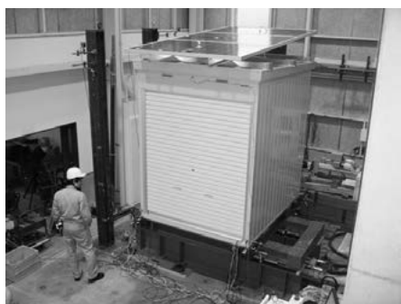
写真 21 物置の振動実験
