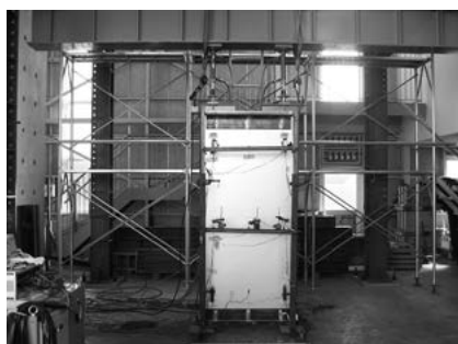
写真 27 アルミ断熱パネルの面内圧縮試験
