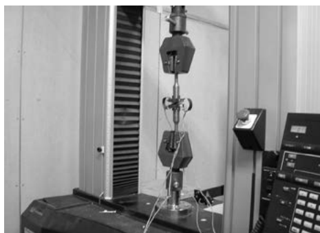
写真 10 金属材料引張試験（100kN 以下）
