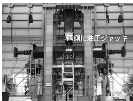
写真 20 柱端接合部試験
