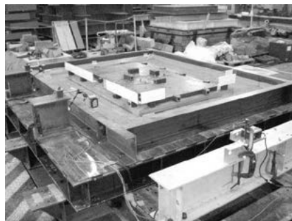
写真23 免震システムの振動実験
