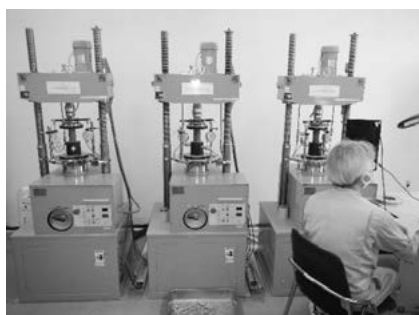
写真3 地盤改良体の圧縮強度試験状況
