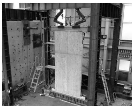
写真8 高さ 4m 耐力壁の面内せん断試験
