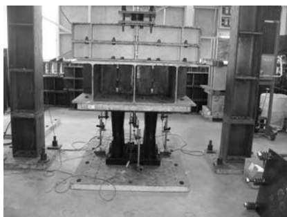
写真 29 プラスチック雨水貯留槽圧縮試験
