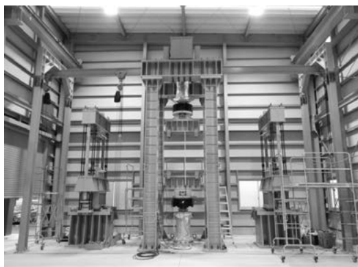
写真 4 杭強度試験棟
