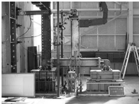
写真 19 柱梁接合部試験（T 形）
