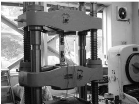
写真 16 高力ボルト摩擦接合部試験
