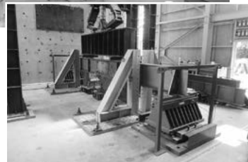
写真 17 梁継手曲げ試験
