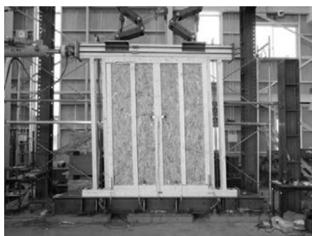
写真7 MPW 耐力壁の水平加力実験
