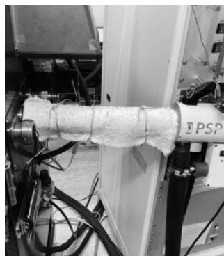
図2 サンプリング管被覆の様子
