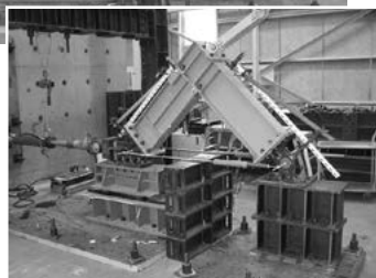
写真 18 柱梁接合部試験（L 形）
