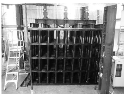
写真 30 プラスチック雨水貯留槽正負交番繰り返し試験
