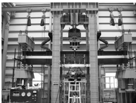
写真 13 H 形鋼の曲げ試験
