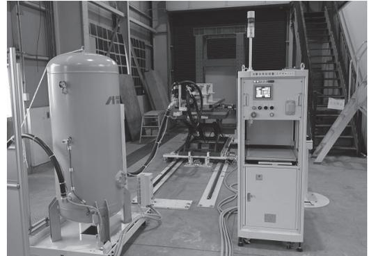
写真2 加撃体発射試験機（エアータンク・制御盤）
