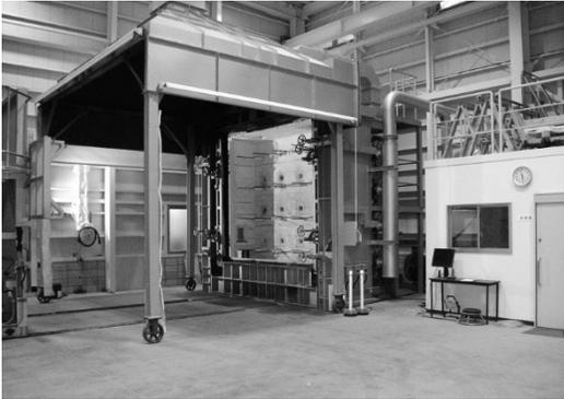
写真4 第二防耐火試験棟大型壁炉(2016年竣工時)
