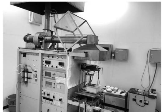
写真7 発熱性試験装置
