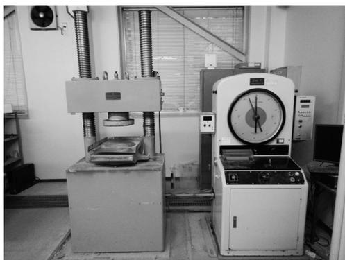
写真：2000kN アムスラー型試験機
