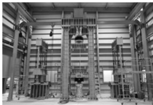
写真 4 杭強度試験装置（全景）
