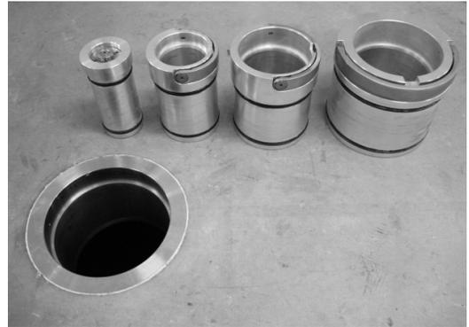
写真2 貫通孔に設けたシリンダセット
