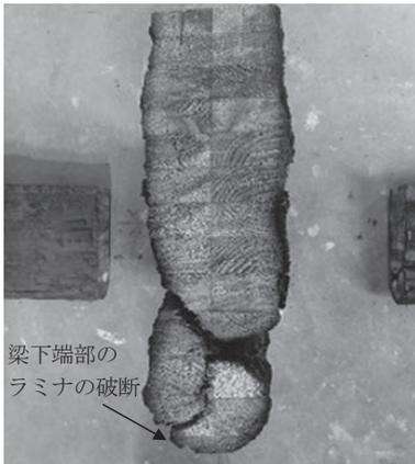
写真2 試験体破壊状況 (試験体③、断面)
