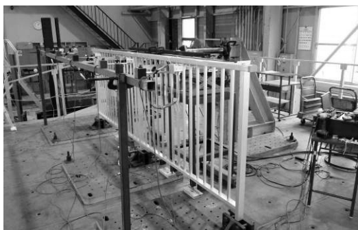
写真3 墜落防止手すり BLT SR:2018 ユニットの水平荷重試験（床支持）BLT SR-05
