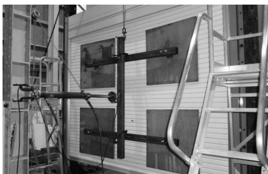
写真4 ガレージ BLT GA:2018 風圧試験（戸）BLT GA-04
