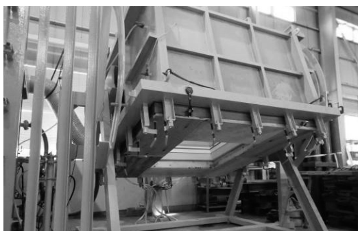
写真2 サッシ（天窗）BLT WDR:2015 ② 水密性試験 BLT WDR-01
