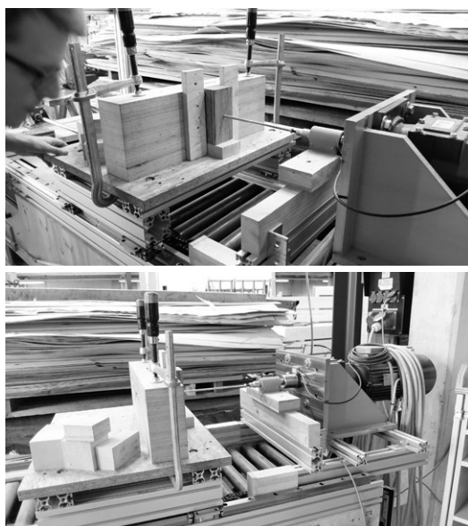
写真4 構造用Screwのねじ込み試験状況
