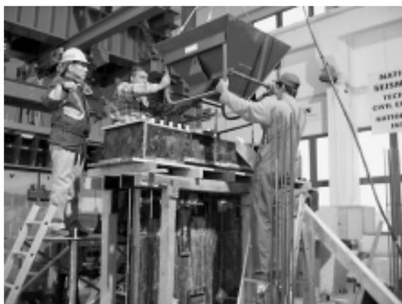
写真5 支保抗は角材、レベル調節は木端で、足場は無し。結構大変な作業です。でも、この職人達、良く働きます。
