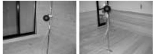
写真5 無垢材内装仕上げを施した室内の室内空気環境測定
