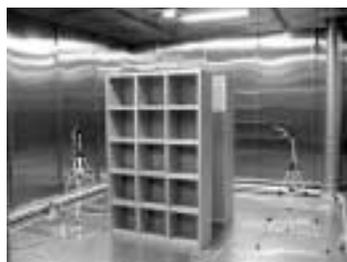
写真2 大型チャンバーを用いた本箱からの化学物質放散量測定
