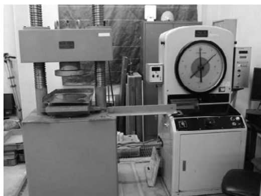
写真1 2000kN圧縮試験機
