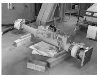
写真1 速度600mm/secアクチュエータ
