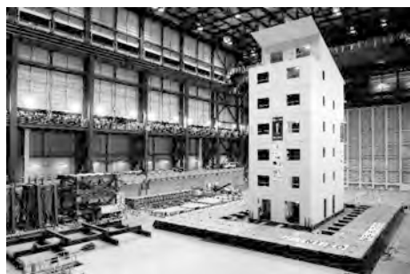
写真 1 X-Lamパネルを用いた木造7階建震動台実験 (IVALSAホームページより引用)
