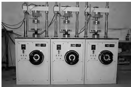
写真1 三連式一軸圧縮試験機
