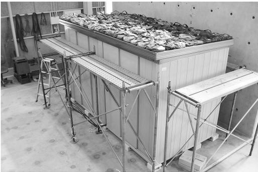
写真1 物置の等分布荷重試験
