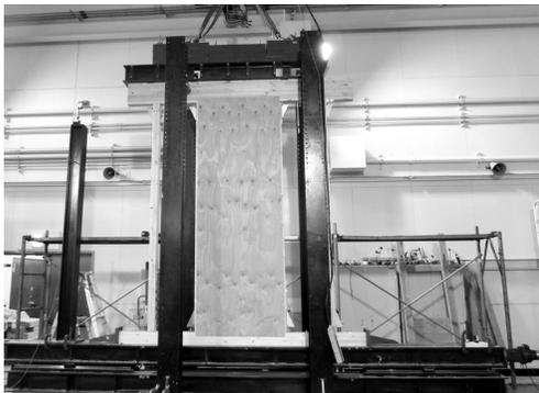
写真1 振動台への試験体の設置
