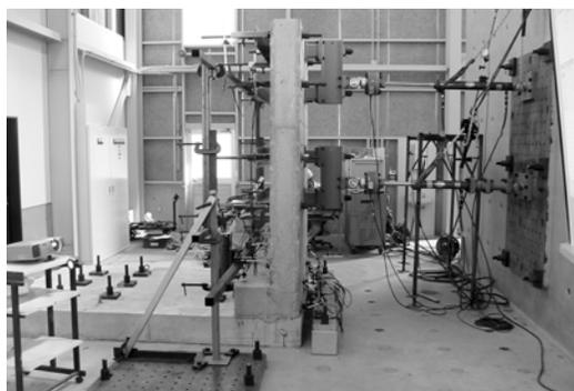
写真5 ブロック擁壁の曲げ加力
