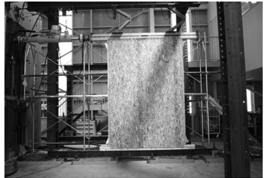
写真5 BLでの木造耐力壁面内せん断試験
