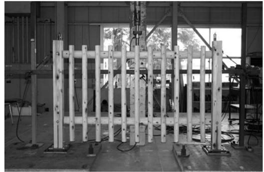
写真18 木造柵の載荷試験
