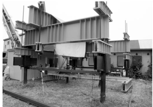
写真2 杭の载荷試験(押し込み载荷)
