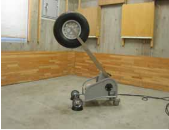
[衝撃源]バングマシン(左)とインパクトボール(右)
