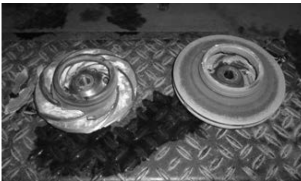
写真1 羽根車の破損状況
