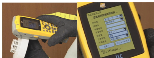
図3 ICタグを用いたトレービリティシステム
