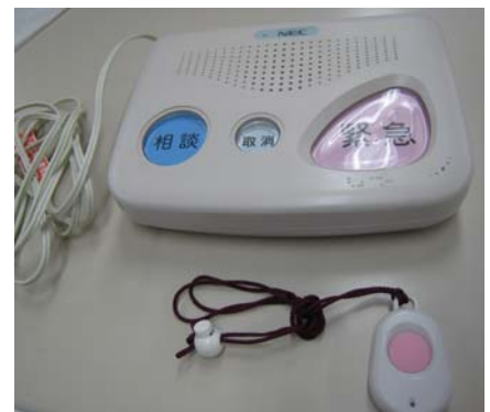
【緊急通報装置】
