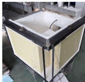
写真5 耐火構造壁の加熱試験
