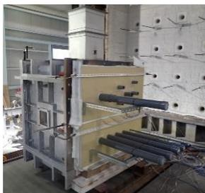
写真4 区画貫通部の加熱試験状況
