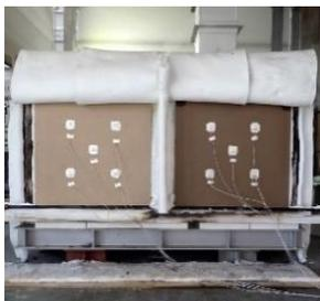
写真6 木質系ボードの加熱試験
