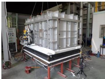
写真7 層間ふさぎの加熱試験（床側加熱）
