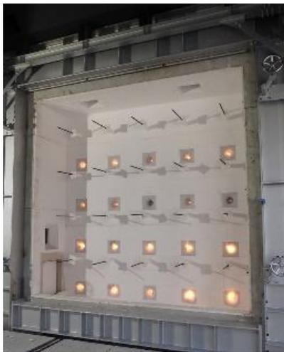
写真1 大型壁加熱炉
