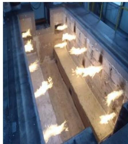
写真2 多目的水平加熱炉
