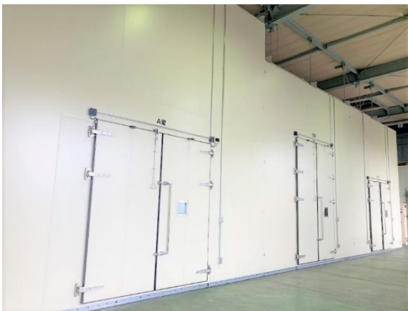
写真 1 3 室型(大型)恒温恒湿試験装置(左:外観写真、右:内部の概要)
