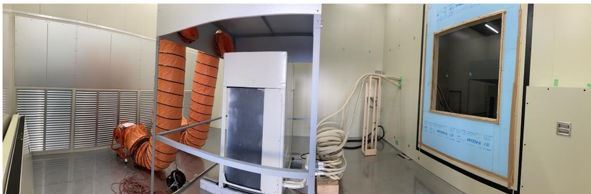
写真 2 3 室型(大型)恒温恒湿試験装置(室内)
