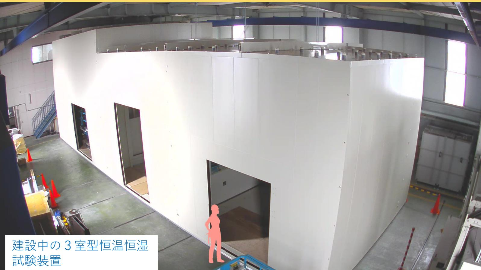
建設中の3室型恒温恒湿試験装置
