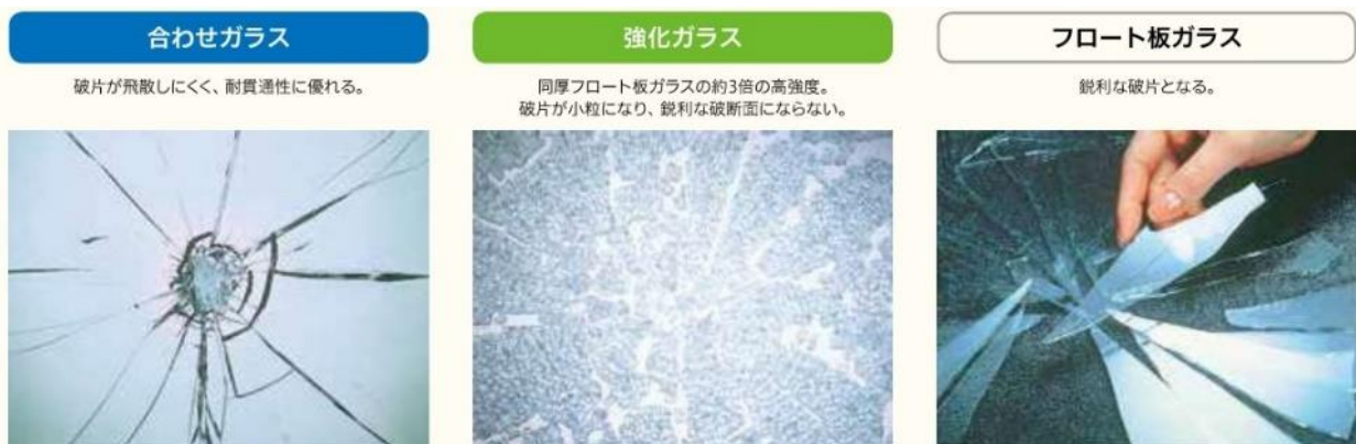
図 各種ガラスの割れ方
