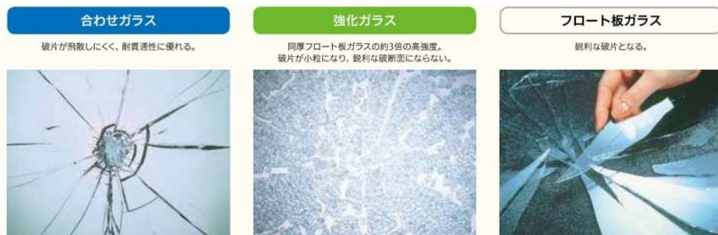
図 各種ガラスの割れ方
