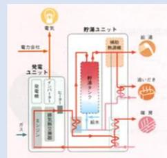
ガスを燃料として高性能なガスエンジンで発電する装置
