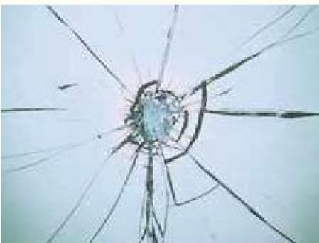
2 枚以上の材料板ガラスに中間膜を挟み全面接着したもので、外力の作用によって破損しても、破片の大部分が飛び散らないようにしたものです。
