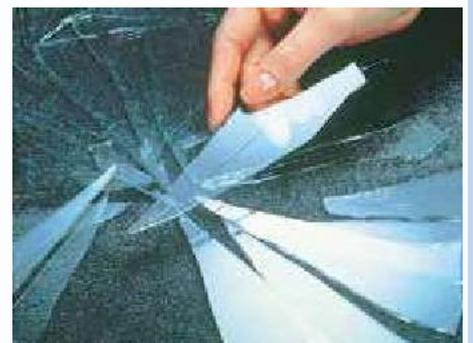
一般的に多く使われているガラスです。強い衝撃では衝撃物は貫通し、鋭利なガラス片が脱落、飛散します。
