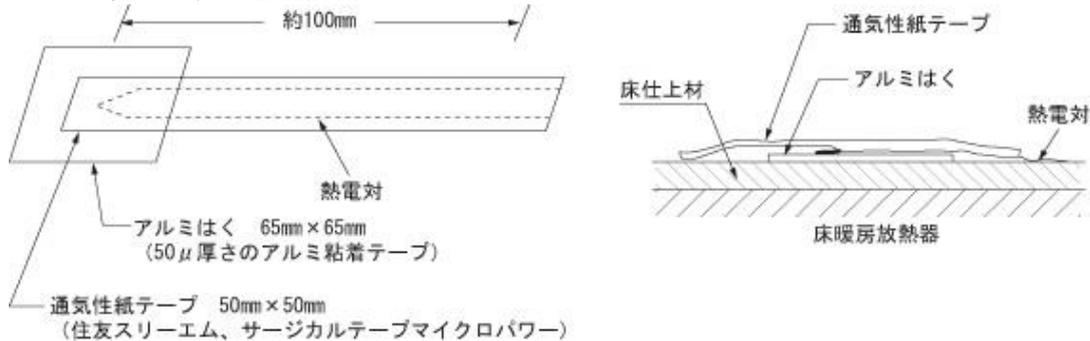
直径φ0.3mmのC.C.熱電対を65×65mmの50μm厚さのアルミ箔を張り付けた上に置き、通気性紙テープをその上にかぶせて貼り付ける。導線は測定点から約100mm以上床仕上げ材の表面に接して導く。サーミスターや抵抗温度計を用いる場合、その感温素子は、充分細かいか薄いもので、表面温度の測定に適したものを熱電対の使用法に準じて取り付けるものとする。測定は多点式熱電対温度記録計または相当設備で行う。
