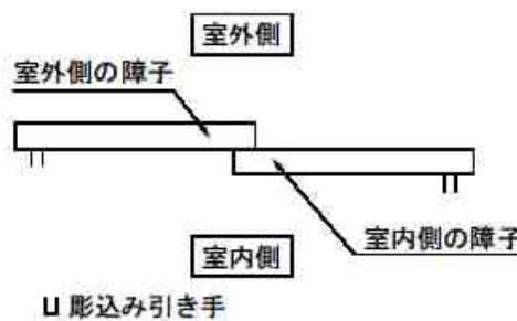
図-6 引違いの彫込み引手取付け例
