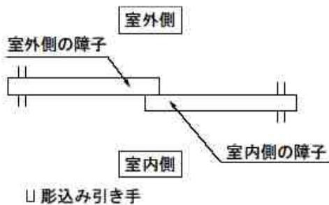
図-5 引違いの彫込み引手取付け例
