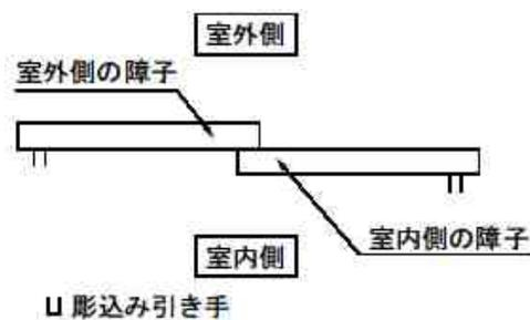
図-6 引違いの彫込み引手取付け例
