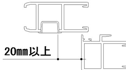
図-11 彫込み引手と召合せ框の距離
