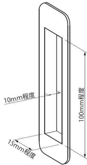
図-8 彫り込み引手寸法の押さえ方
