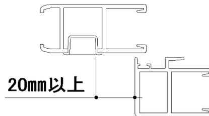
図-9 彫込み引手と召合せ框の距離
