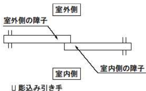
図-5 引違い（出入口）の彫込み引手取付け例
