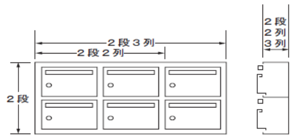
図-1 標準化対応郵便受箱の構成
