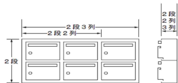
図－1 標準化対応郵便受箱の構成
