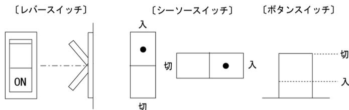
iii) 能力切替、温度調節及び時間設定時におけるレバー、ダイヤル等の操作方向及び回転方向は次による。
