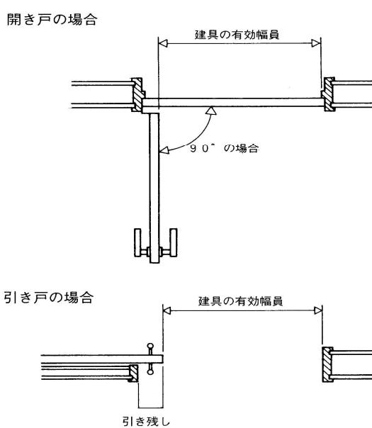
図-1 玄関ドアの有効幅員
