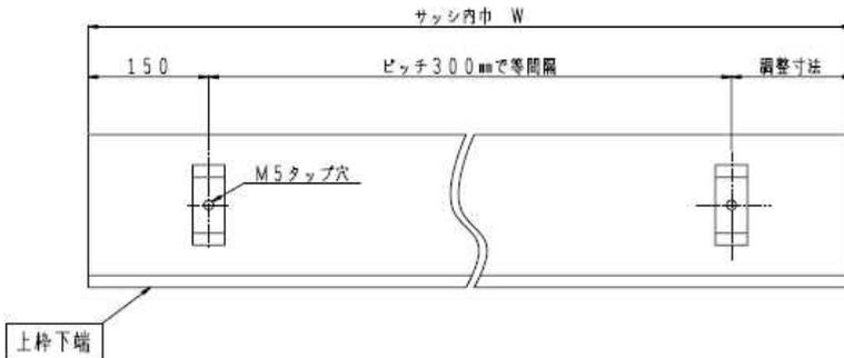
図一3 ドア・クローザの上枠のハンガーレール取付け用タップ加工位置 単位 (mm)
