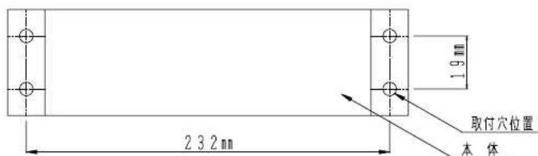
図-1 開き戸用ドア・クローザの取付穴位置
