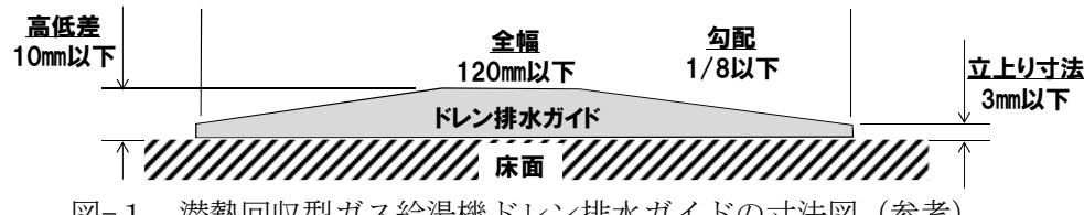
図-1 潜熱回収型ガス給湯機ドレン排水ガイドの寸法図 (参考)
