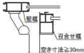
図-12 把手と召し合わせ框との空き寸法
