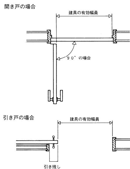
図-1 玄関ドアの有効幅員
