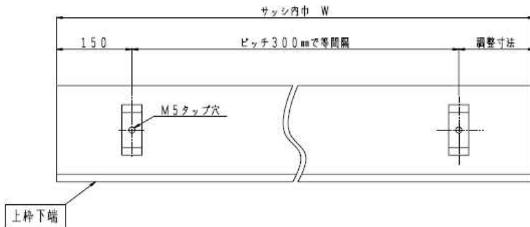
図-3 ドア・クローザの上枠のハンガーレール取付け用タップ加工位置 単位 (mm)
