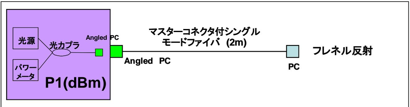
図OC2-1 反射減衰量測定装置の校正
