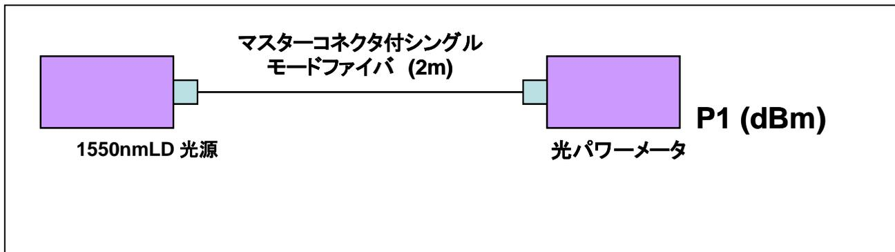
図OC1-1 挿入損失測定装置の校正
