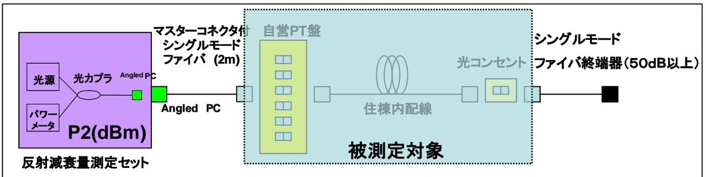
図OC2-2 反射減衰量の測定
