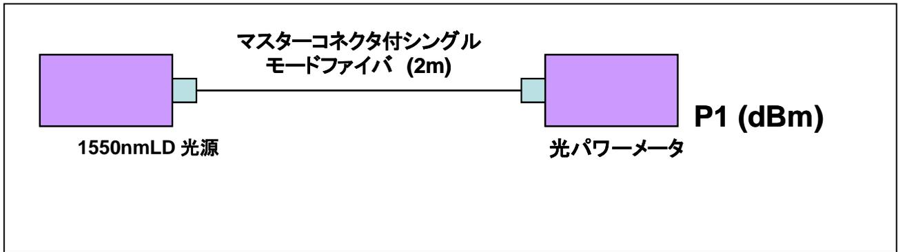
図参考-01-1 挿入損失測定装置の校正
