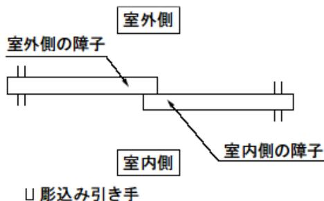
図-5 引違い（出入り口）の彫込み引手取付け例
