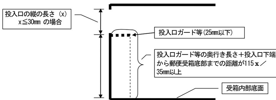
図-2 投入口の縦の長さ (x) が  $x \leq 30\text{mm}$  の場合
